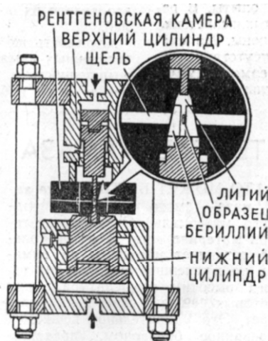
Схема установки. Давление на образец, находящийся в канале бериллиевого конуса, передается через литий верхним поршнем. Чтобы создать высокое внутреннее давление, бериллиевый конус помещают в стальной конус, а его запрессовывают в стальную поддержку при помощи нижнего поршня. В стальном конусе есть канал для входа рентгеновых лучей и прорез для выхода лучей. Конструкция камеры позволяет получать на одной пленке два снимка: под давлением и без давления.
